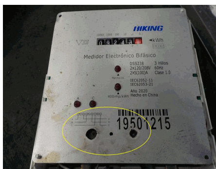
PLACA DE CARACTERÍSTICAS PERFORADO (Parte inferior)
