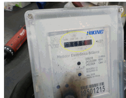
TAPA PRINCIPAL FUERA DE POSICIÓN (No permite tomar lectura correcta)
