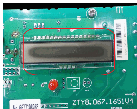
REGISTRADOR DETERIORADO (Visualizador)
