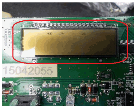
REGISTRADOR DETERIORADO (Visualizador)
